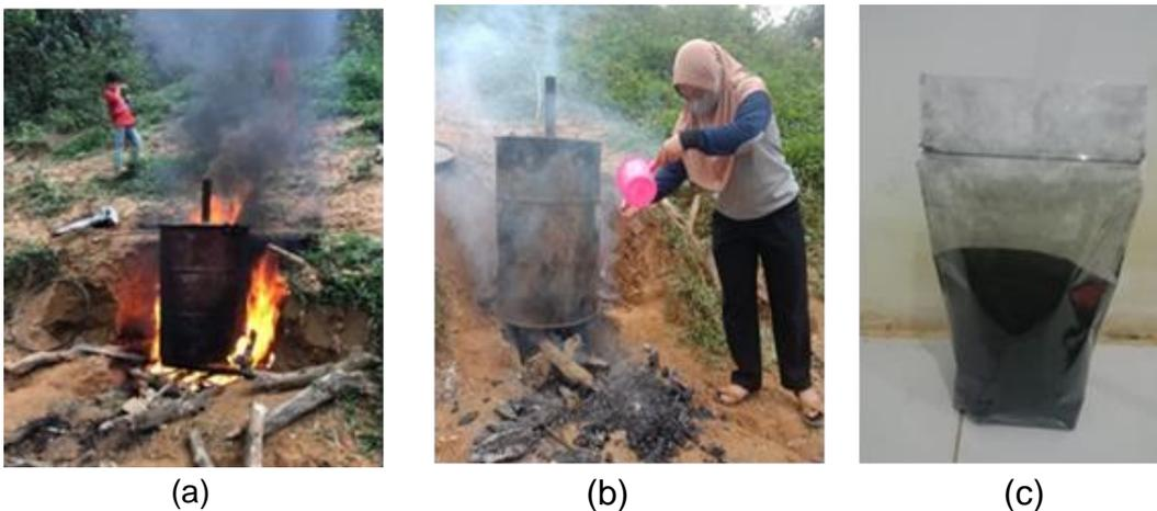
**Gambar 7.** Demonstrasi pembuatan *biochar* dari potongan kayu dan ranting
