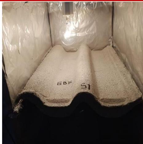
Gambar 5. Pengujian penyerapan panas
