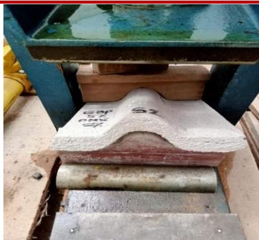
**Gambar 3.** Pengujian beban lentur
